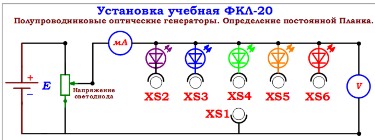
Рис. 1. Упрощенная блок-схема экспериментальной установки для исследования светодиодов и определения постоянной Планка ФКЛ-20
