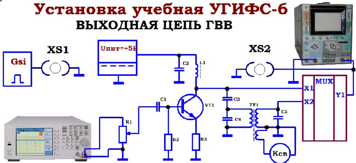
Рис. 3.1. Принципиальная электрическая схема учебной установки УгиФС-6 для исследования выходной цепи транзисторного генератора с внешним возбуждением.
