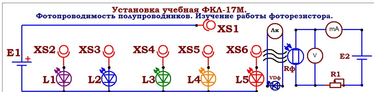
Рис. 1. Блок-схема опыта для изучения работы фоторезистора.
