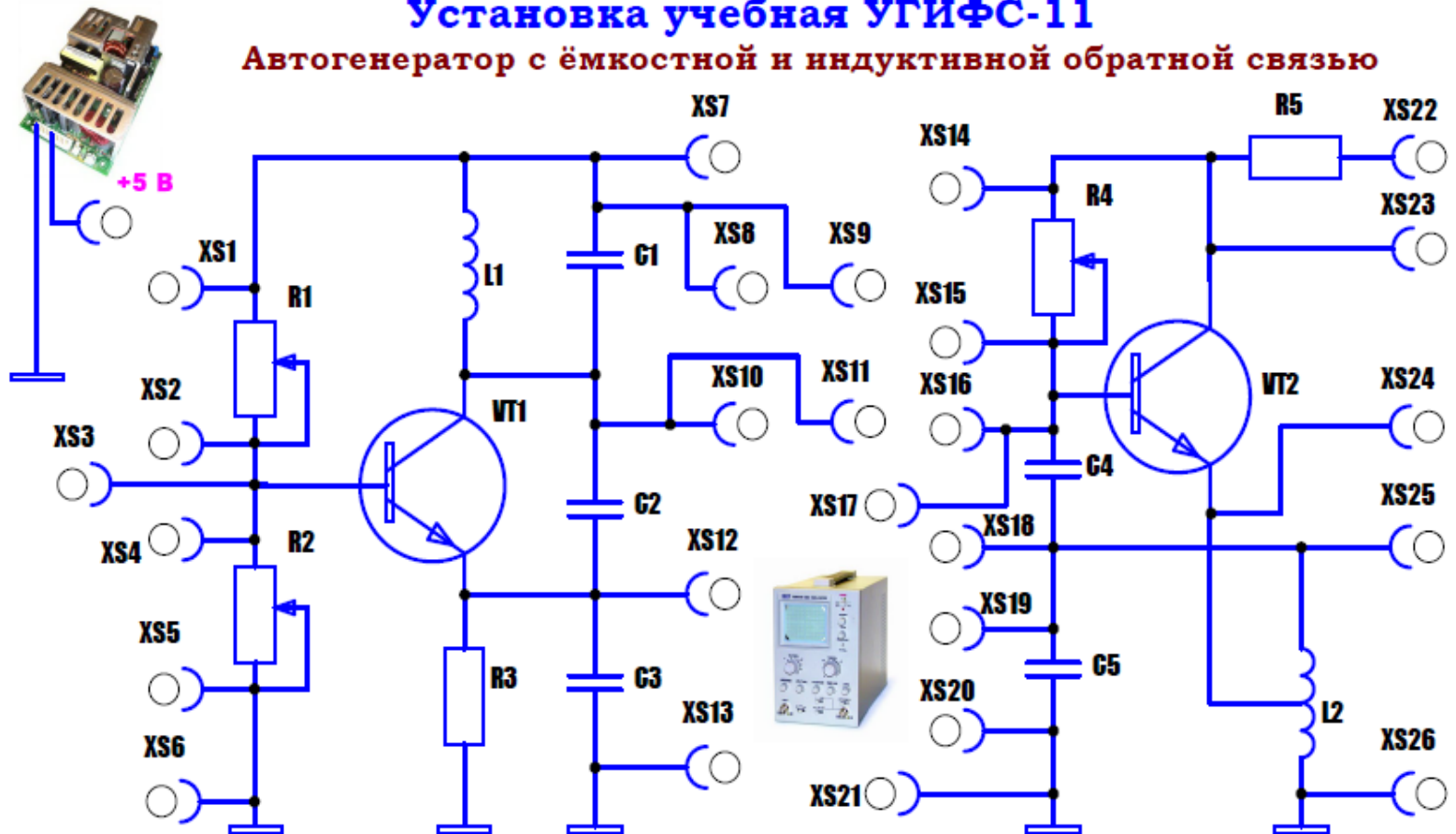
Рис. 2.1 Принципиальная электрическая схема учебной установки УгиФС-11 для исследования трёхточечных автогенераторов гармонических колебаний.
