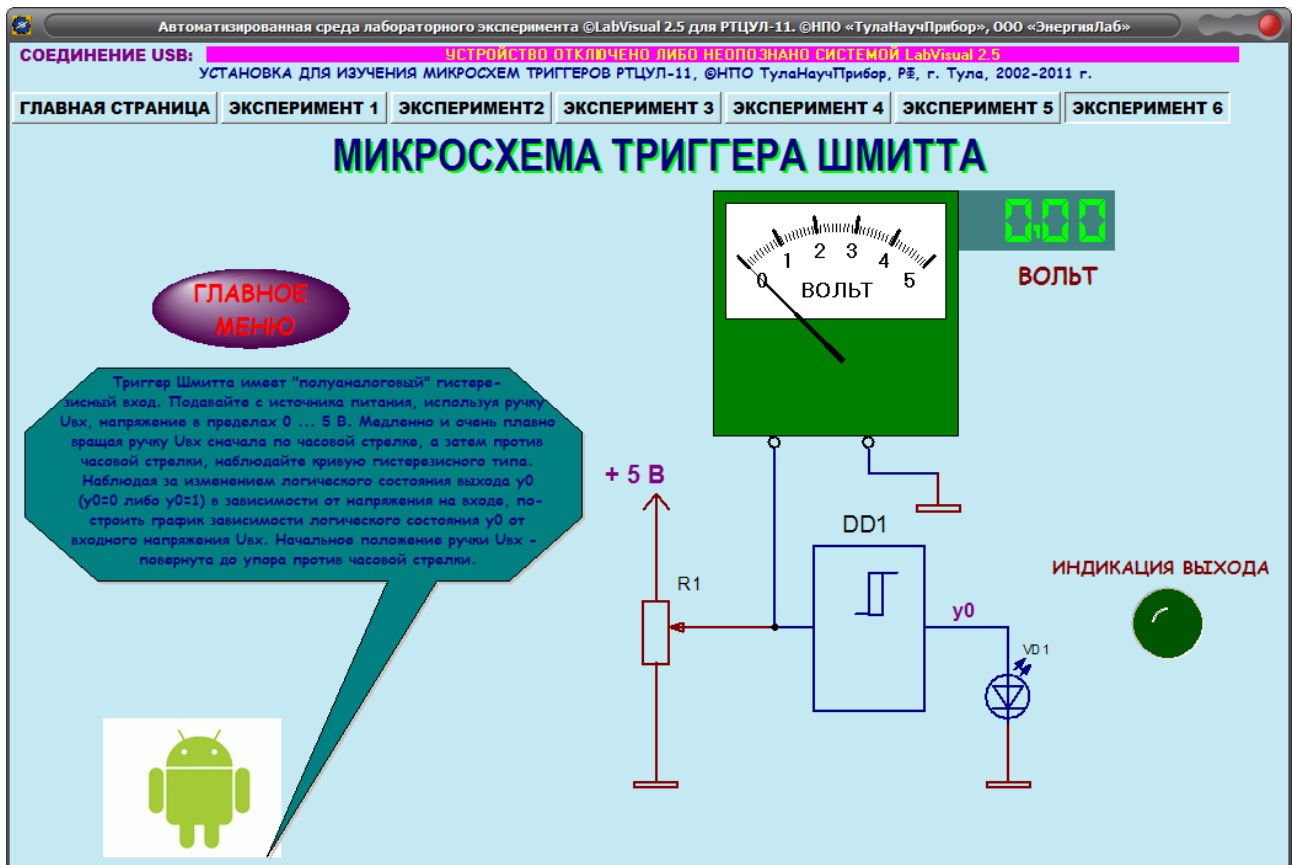
Рис. 4.7. Эксперимент по изучению микросхемы триггера Шмитта.
