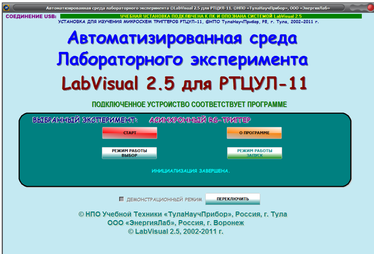
Рис. 4.1. Главное окно программы-оболочки LabVisual для работы с экспериментальной установкой РТЦУЛ-11К.
