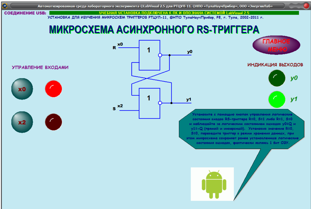
Рис. 4.2. Эксперимент по изучению микросхемы асинхронного RS – триггера.
