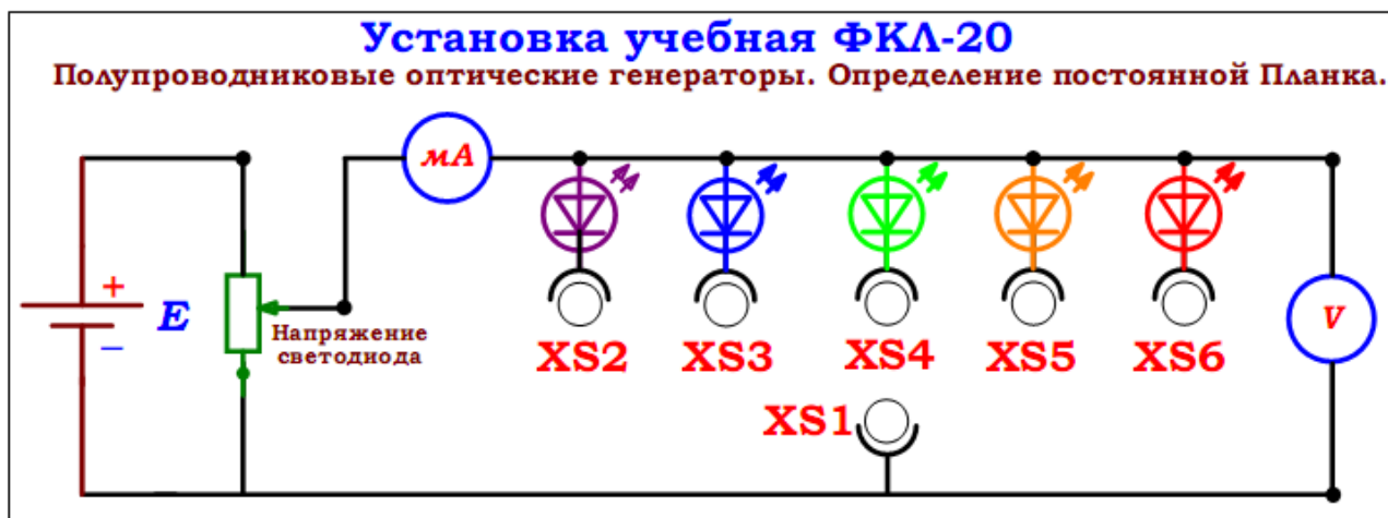
Рис. 16. Упрощенная блок-схема экспериментальной установки для исследования светодиодов и определения постоянной Планка ФКЛ-20
